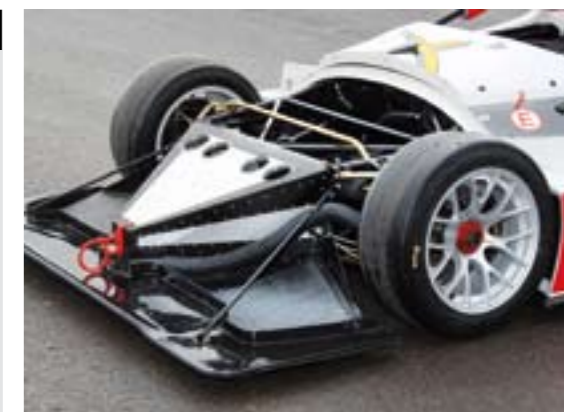
Mit Sicherheit leicht: Dank Knautschzonen (hier die vordere Crashbox) erfüllt der SR3 FIA-Sicherheitsanforderungen
