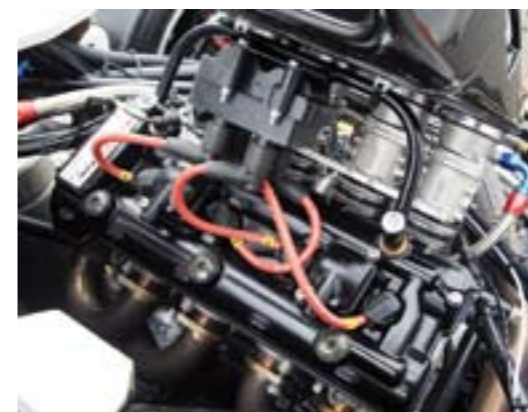
Mehr Hub: Aus 1,5 statt 1,3 Litern schöpft der von Power-tec getunte Hayabusa-Motor 260 PS (Serie: 197 PS)
